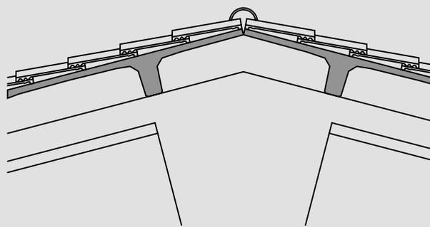
Schema di colmo con manto in tegole di cemento.
