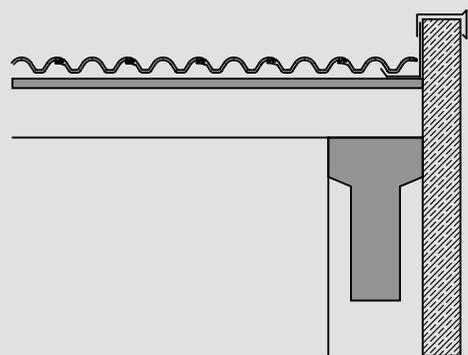
Schema di raccordo testata tra manto di copertura e tamponamento esterno.
